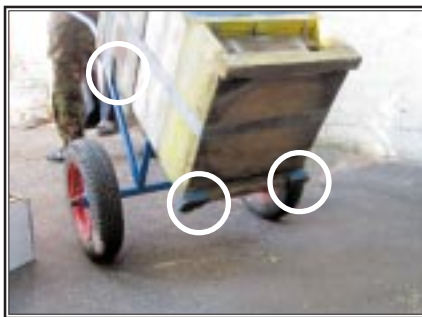
Нижні гнізда знизу та бічні обмежувачі зверху візка надійно фіксують вулик під час перевезення
